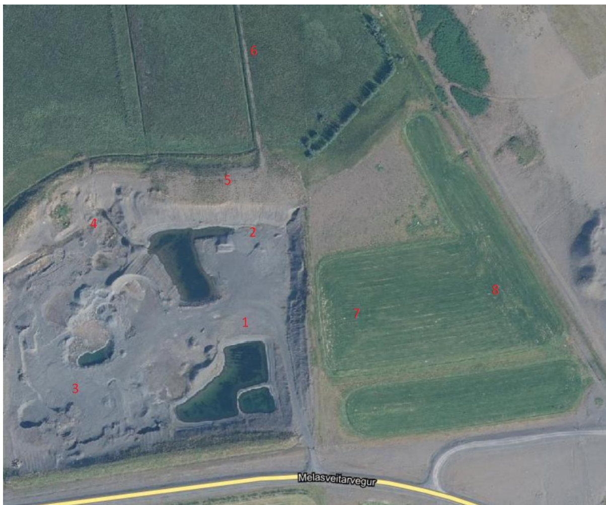
MYND 2.5 Borholur sem teknar voru sumarið 2020 til að athuga efnasamsetningu og efnismagn á fyrirhuguðu framkvæmdarsvæði. Mynd: Landmælingar Íslands
